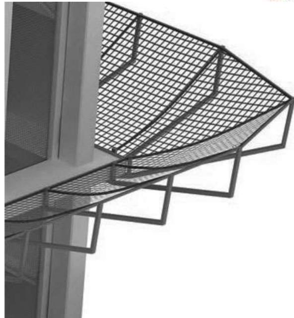
**Sistema V:** è la rete di sicurezza con fune sul bordo attaccata a un sostegno a forca. La sua installazione è di tipo. La sua funzione è quella di proteggere da cadute sia di tipo laterale che di tipo verticale che si verificano da due piani”.
